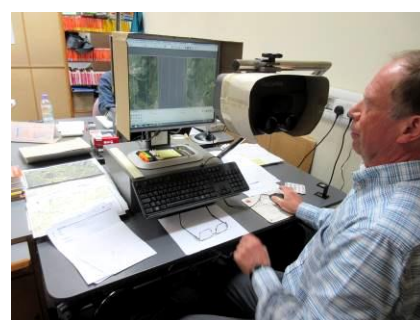
ロビンがコンピュータ式の図化機を操作して見せてくれた
