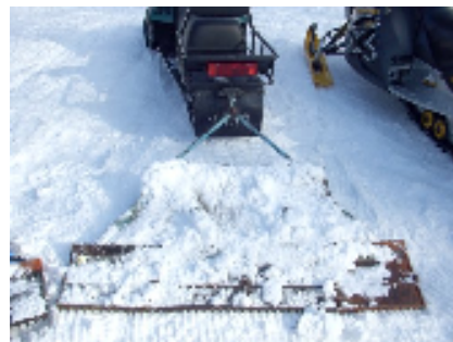
モービルの後ろで板を引いて幅広のトラックを整備する
