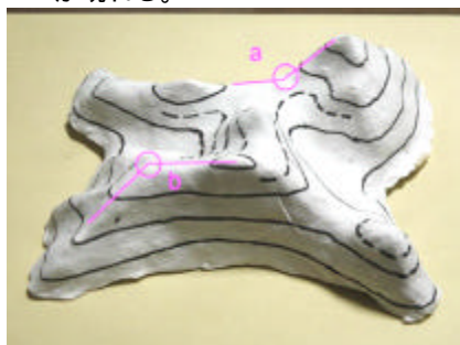
図 1 : a 点は傾斜が急な尾根から平らな部分への変換点なので、「尾根の根本」となり、b 点は傾斜が緩やかな尾根から急な尾根への変換点なので「尾根の肩」となる
