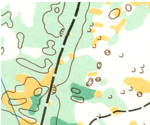
1983年に作成された旧マップ(等高線間隔は1m。凹地の記号が傾いているのは磁北線を傾けてあるため)
