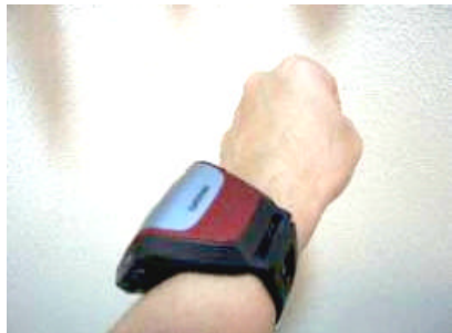
Forerunner305 を腕に装着した様子 少し大きめの腕時計といった感じで、写真に写っている側に GPS アンテナが内蔵されており、ランニング中に上空からの衛星信号が受信しやすくなっている。
