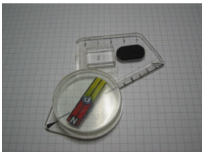
スト社のハンディーコンパス。地図と離れるので、正置の精度が落ちやすい。
