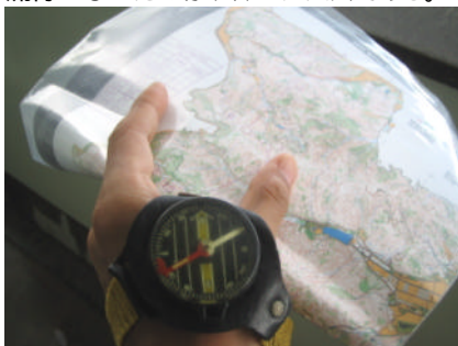
スト社のハンディーコンパス。地図と離れるので、正置の精度が落ちやすい。
