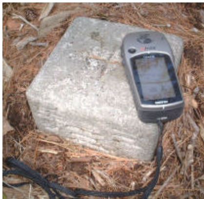
菅平高原の林の中にひっそりとある三角点。国土地理院の測定データと GPS の測定データを照合して誤差を測定しているところ。
