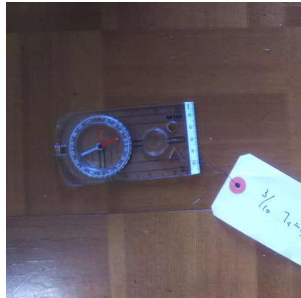
(12) プレートコンパス
